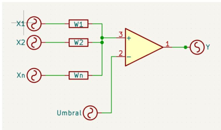
Las neuronas están compuestas por la entrada  $X_1, \dots, X_n$  representada por el voltaje y una resistencia  $W_1, \dots, W_n$  que representa el peso, el problema reside en que las resistencias tienen que cambiar de valor y almacenar ese valor lo cual no es tarea sencilla.
