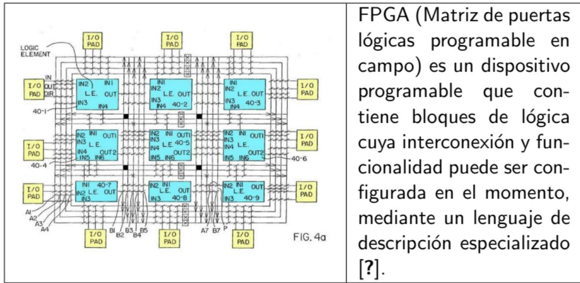
FPGA (Matriz de puertas lógicas programable en campo) es un dispositivo programable que contiene bloques de lógica cuya interconexión y funcionalidad puede ser configurada en el momento, mediante un lenguaje de descripción especializado [?].
